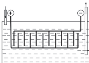
Фиг. 1. Схема на горивна клетка [2].
