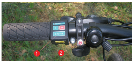
Фиг. 3. Разположение на органите за управление на лявата ръкохватка:
