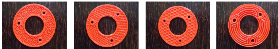
Фиг. 6. Различни видове запълване на вътрешността на обемно тяло
