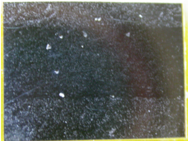
Фиг.4. Питинги върху лазерно обработен образец (обр.4) след електрохимично изпитване
