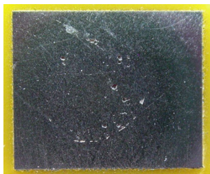
Фиг. 2. Корозионни разрушения – питинг и процепна корозия – върху повърхността на образец 4 (стомана X18H10T след лазерно претопяване на повърхността) след електрохимичните тестове
