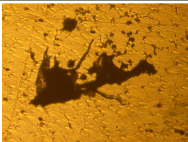
Фиг. 3. Корозионни разрушения – питинг – върху повърхността на образец 0 (стомана X18H10T в състояние на доставка) след електрохимичните тестове, x63
