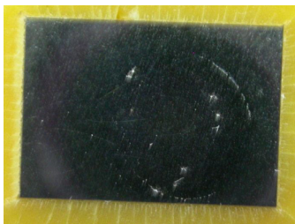
Фиг. 1. Корозионни разрушения – питинг и процепна корозия – върху повърхността на образец 0 (стомана X18H10T в състояние на доставка) след електрохимичните тестове
