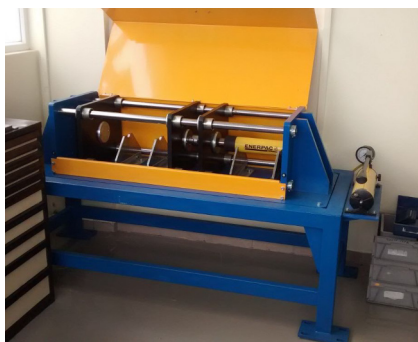
Фиг. 8. Стенд за калибриране – общ вид на примерните модели на стенда
