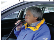
Фиг. 6. Устройство за блокиране на запалването при употреба на алкохол
