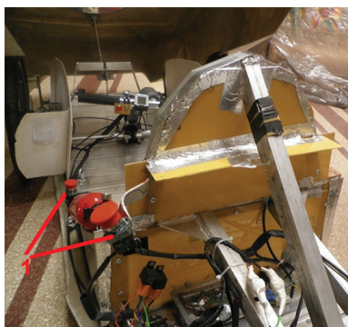
Фиг. 5. Аварийни бутони за прекъсване на захранването
