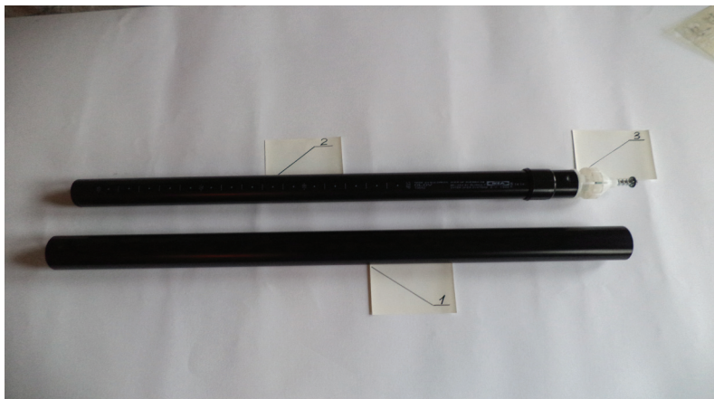
Фиг.2. Елементи на регулируем крак за маса
