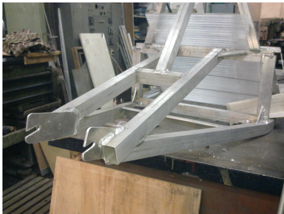
Фиг. 3 Захващане на електродвигателя към рамата на автомобила.
