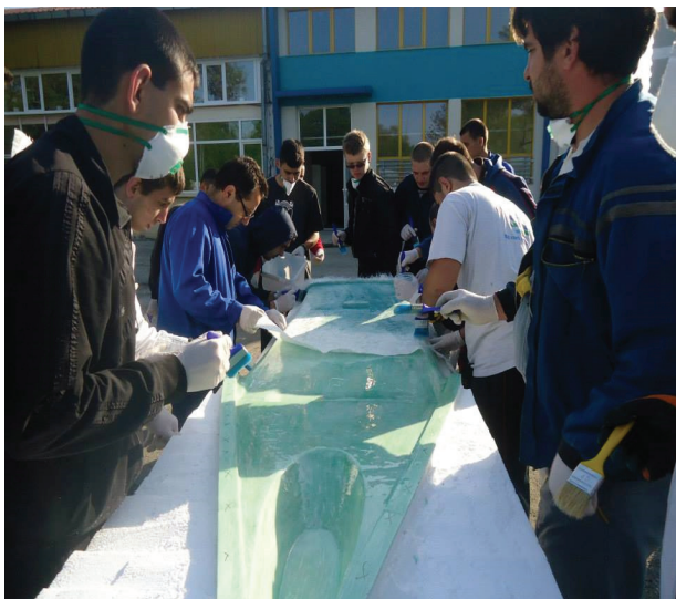
Фиг. 6. Процес на отливане на купето на прототипа.
