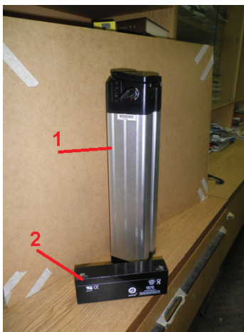
Фиг. 3. Батерии включени в електрическата система на автомобиля: 1 – Li-ion батерия 48v 14.5 Ah/696wh, 2 - Батерия аксесоарна – 12v 2.1Ah
