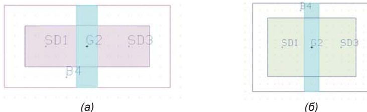
(а) (б) Фиг. 5. Топология на (а) NMOS и (б) PMOS транзистор.
