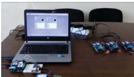
Фиг. 7. Безжична система за измерване на температура и влажност
