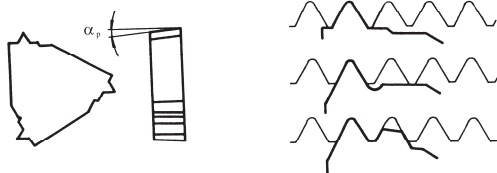
Фиг. 5. Непрезаточваеми пластини на фирмата Sandvik Coromant и профил на режещите им ръбове
