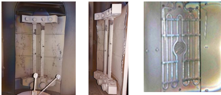
Фиг. 4. Външен вид на: а) графитовият нагревател на „TITAN 1-4“; б) никеловият нагревател на „AURORA“
