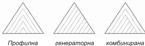
Фиг. 6. Схема на изрязване на прибавката с резбови ножове
