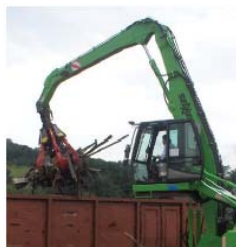
Фиг. 4. Грайфер за сортиране на материали на фирма Mantovanibenne.
