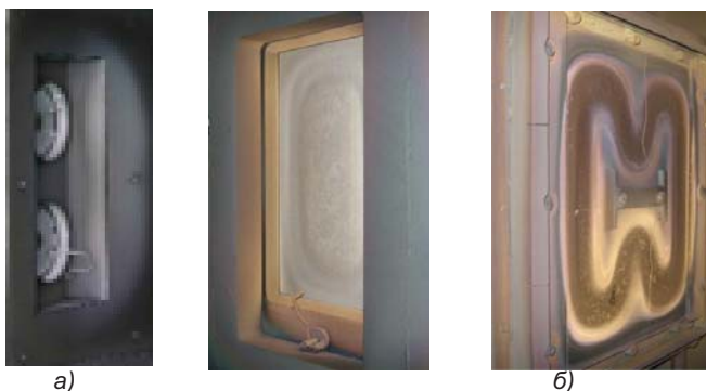
Фиг. 3. Външен вид на изпарителите: а) двоен електродъгов изпарител на AURORA; б) електродъгов изпарител (в ляво) и магнетрон (в дясно) на TITAN 1-4;
