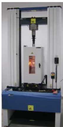
Фиг.1. Изпитвателната машина „гсптрон-3384“
