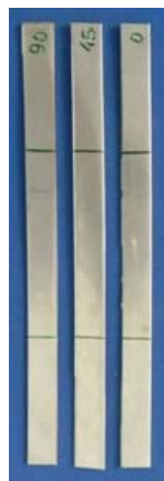
Фиг. 2. Пробни тела за едномерен опън от X5CrNi18-10: а) схема с основни параметри по стандарт ISO-6892-1, б) общ вид на образеца, 1- място за маркиране, 2 - зона за захващане, 3 - реперни линии, 4 – работна зона, L_0=50\text{mm} , L_c=65\text{mm} , b_0=0,8\text{mm} , L_t=45\text{mm} и b_0=25\pm 1\text{mm} .
