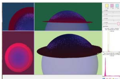
Фиг.4. Панел на софтуерен продукт SA-3DSC за анализ на сферичност и определяне радиуса на цифровия образ
