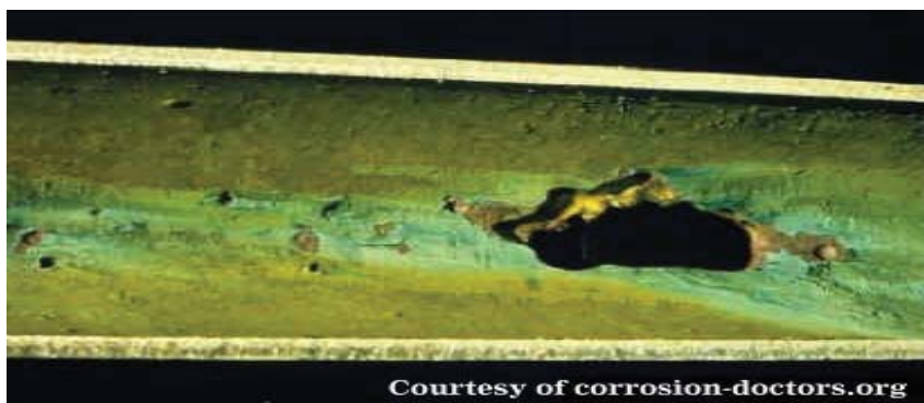
Снимка 7. (Селективно разтваряне – атакува се един от компонентите на сплавта)
