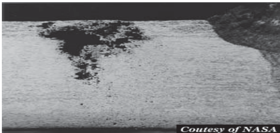
Снимка 5. (Питингова корозия – точки с диаметър 0.1 – 2 mm хром-никелови стомани в морска вода)
