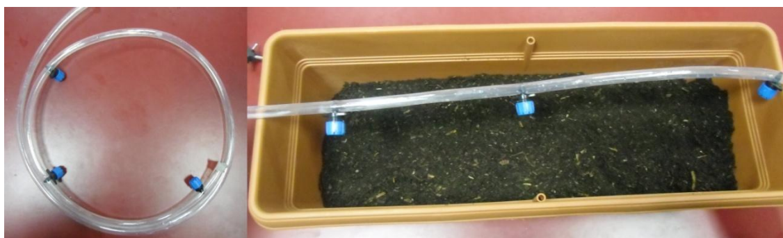
Фиг. 1. Водна тръба и капко-разпръсквателите по тръбата
