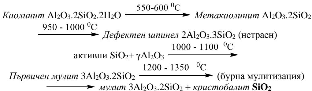
схема 1: Термични превръщания при нагряване на минерала каолинит
