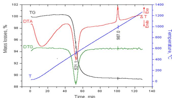
Фиг. 3. Деференциално термичен анализ на обогатен каолин B0- глазура
