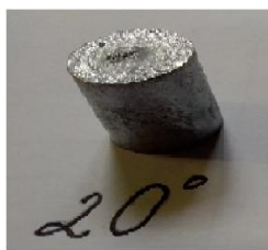
Фиг. 5 Газов мехур, получаващ се при заливане на форма с температура 20 °С.
