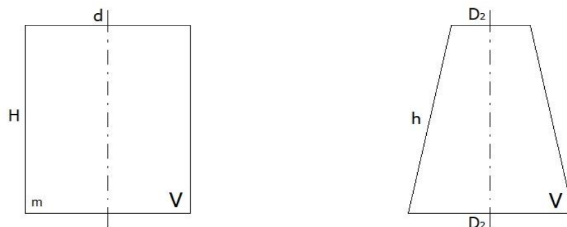
Фиг. 2 Форма на пробните тела - цилиндрична и конусовидна част.
