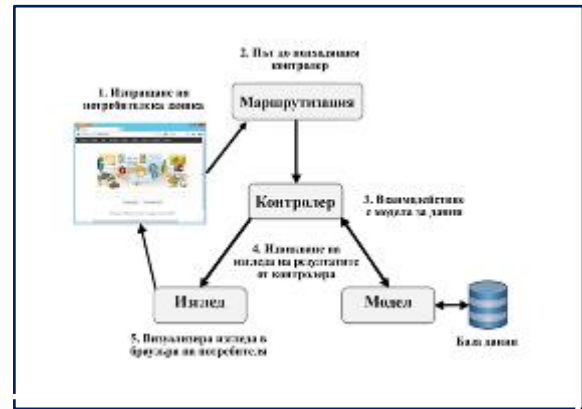
Фиг. 1. Принцип на работата на MVC модела.
