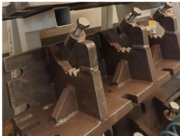
Фиг. 13. Приспособление за механично обработване на ножове за грайферни кофи на втора установка.
