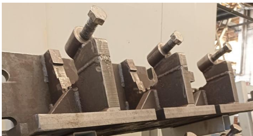
Фиг. 9. Приспособление за механично обработване на ножове за грайферни кофи на първа установка.
