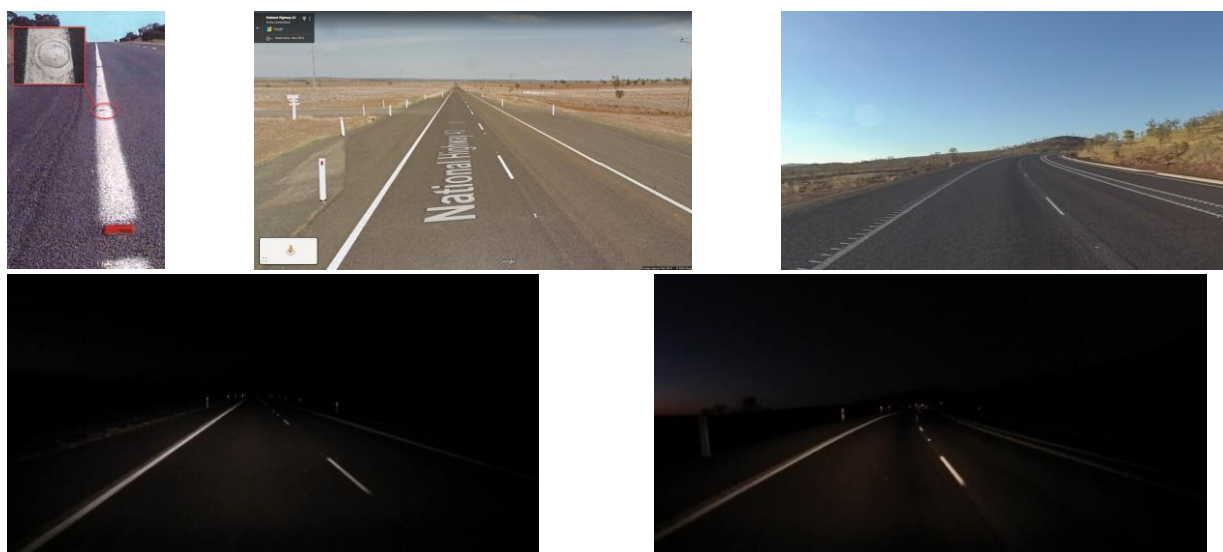
Фиг. 3. Противодействие на умора при управление – маркировка с добри светлоотразителни характеристики, повдигнати маркери (RPM), термопластична аудио тактилна маркировка (ATLM) и вертикални стълбчета. Снимков материал – Южна Австралия, Куйнсланд и Западна Австралия.
