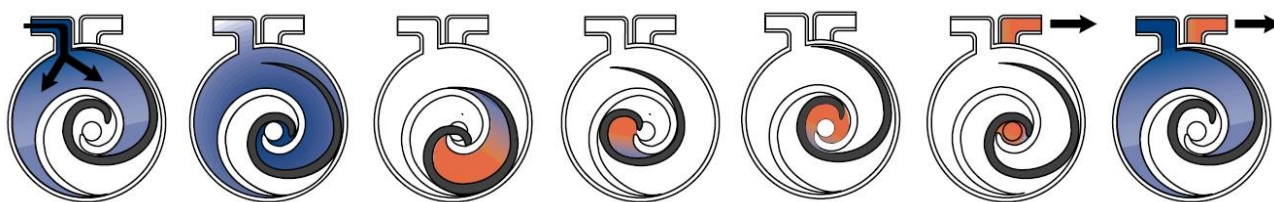
Фиг. 3. Цикли на работа на спирален компресор
