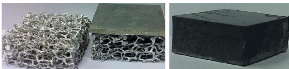
Фиг.4. Алуминиева пяна преди и след закрепването на алуминиевата плоча (вляво); PCM/CENG пяна (вдясно) [21].
