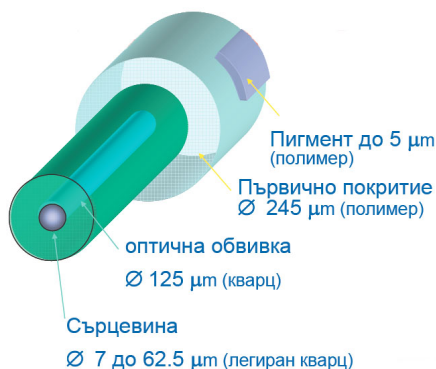
фиг. 1 Структура на оптичното влакно
