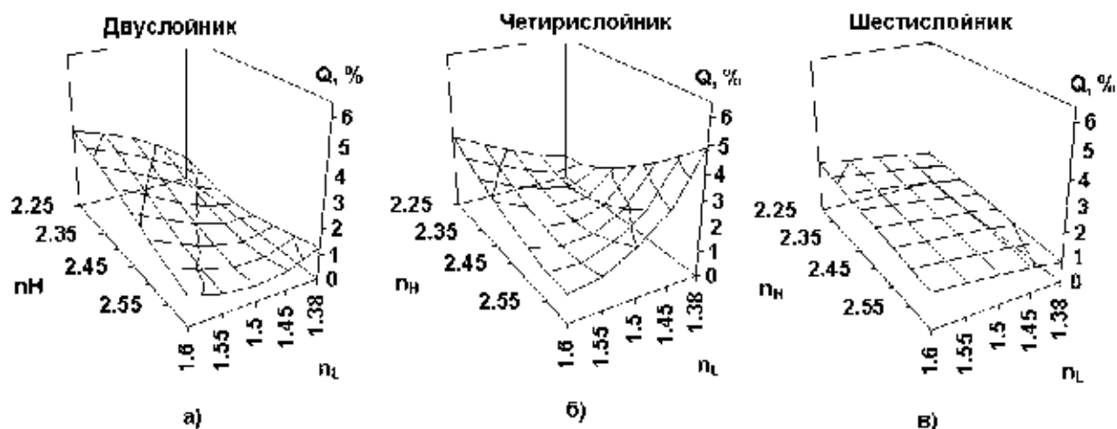
Фиг. 3. Зависимост на средно квадратичното отражение Q на многослойни просветляващи покрития от слоеве с висок и нисък показател на пречупване n_H и n_L върху Si подложки за видимия спектрален диапазон: а) двуслойно; б) четирислойно; в) шестслойно.
